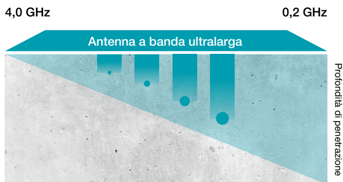
Proceq GPR Live copre tutte le frequenze da 0,2 a 4,0 GHz con un singolo strumento. Le frequenze più basse permettono di raggiungere profondità di penetrazione elevate, mentre quelle più alte consentono di rilevare oggetti di piccole dimensioni.
